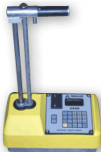
Mesure de l'humidité
